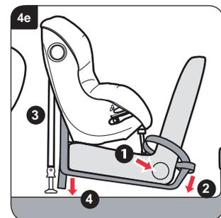
Przesunąć końce pętelek pasów ściągniętych pomiędzy przednim siedzeniem i z powrotem, jak przedstawiono na **rysunku 2d** i **1 2e**. Przeprowadzić końcówki zapięcia ściągniętych pasów wokół fotela samochodowego i przez pętelki **2**. Zamocować końcówki zapięcia pasów do klamer z tyłu fotelika dziecięcego **3**. Tymczasowo zacisnąć pasy ściągnięte, pociągając luźne końce w dół. **4**.
