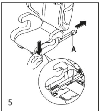
W celu zamontowania fotelika w samochodzie należy wysunąć łączniki ISOFIX (A). Należy wcisnąć dźwignie zatrzaszkowe znajdujące się po obu stronach siedziska i pociągnąć łączniki ISOFIX do tyłu aż do oporu.
