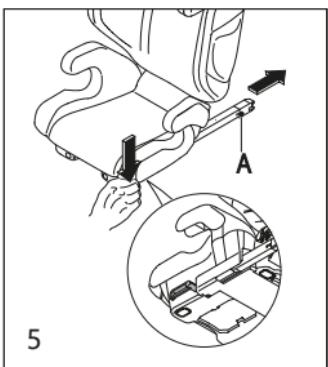
Pour le montage dans votre véhicule, les connecteurs ISOFIX (A) doivent être sortis. Pour cela, appuyez sur les leviers de verrouillage placés sur les côtés de l'assise et sortez les connecteurs ISOFIX en arrière jusqu'en butée.
