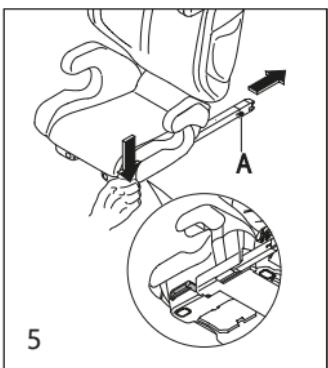
Zum Einbau in Ihr Fahrzeug müssen die ISOFIX-Konnektoren (A) ausgefahren werden. Dazu drücken Sie die Rasthebel an den Seiten des Sitzteils und ziehen die ISOFIX Konnektoren nach hinten bis zum Anschlag heraus.
