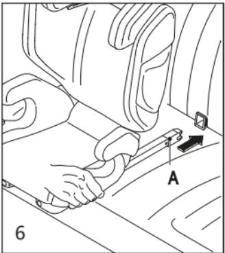
Encochez les connecteurs ISOFIX (A) dans l'arceau Isofix, le repère vert des deux connecteurs devant être visible. Vérifiez le verrouillage en tirant des deux côtés sur l'assise.
