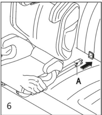
Наденьте коннекторы ISOFIX (A) на скобы крепления Isofix, при этом на обоих коннекторах должна быть видна зеленая маркировка. Приверните надежность фиксации, потянув с двух сторон за поверхность сиденья.
