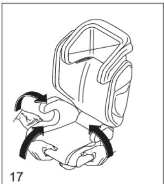
Ziehen Sie die unteren Kunststoffleisten aus den entsprechenden Schlitzen. Streifen Sie den Bezug von außen beginnend über die Gurtführungen.
