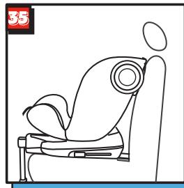
Boczny element ochronny powinien być zainstalowany po stronie najbliższej drzwi pojazdu.
