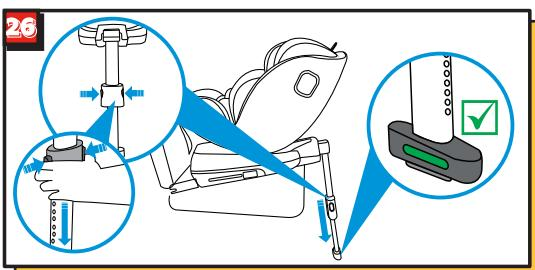
Потяните опорную стойку из-под нижней части автокресла до полного выдвижения. Нажмите 2 кнопки регулировки и вытягивайте опорную стойку до тех пор, пока она не упрется в пол автомобиля.
