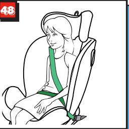
Umieść część ukośnego pasa bezpieczeństwa i część biodrowego pasa bezpieczeństwa z boku zamka pasa bezpieczeństwa pojazdu w dolnej prowadnicy pasa. (Rysunek 48)
