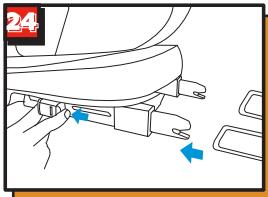
Presione 2 botones ISOFIX simultáneamente y desconecte los conectores ISOFIX. (Figura 24)
