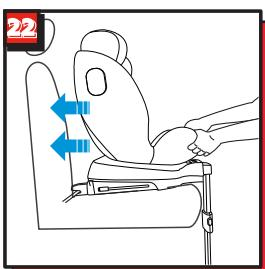
Setzen Sie die beiden ISOFIX in die Führungsstücke ein, bis die ISOFIX auf beiden Seiten einrasten. Die ISOFIX-Anzeige sollte auf beiden Seiten grün leuchten (Abb.20,21).
