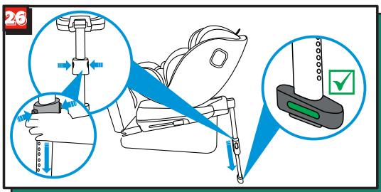
Потягніть опорну стійку з-під нижньої частини автокрісла до повного висування. Натисніть 2 кнопки регулювання і витягуйте опорну стійку доти, доки вона не впереться в підлогу автомобіля.
