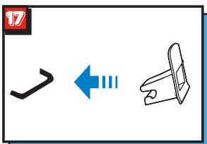
Jeśli pojazd nie jest standardowo wyposażony w szyny ISOFIX, przymocuj dwie dostarczone szyny wycięciem do góry do dwóch punktów montażowych ISOFIX w pojeździe.
