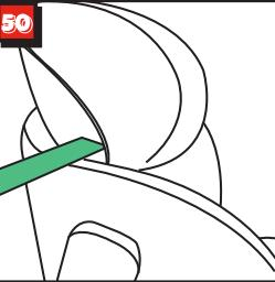
Inserte la parte diagonal del cinturón de seguridad en el soporte del cinturón para que no se retuerza. (Figura 50)
