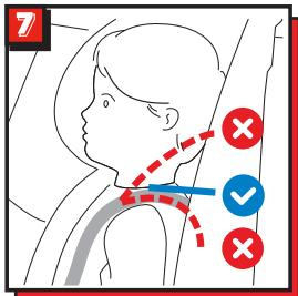
Bei der Sicherung mit einem 5-Punkt-Gurt muss die Kopfstütze so eingestellt werden, dass sich die Schultergurte auf gleicher Höhe mit den Schultern des Kindes befinden (Abb.7).
