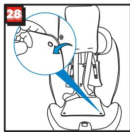
Lösen Sie die Knöpfe auf der Rückseite und drehen Sie die obere Hälfte der Abdeckung nach oben und die untere Hälfte nach unten (Abb. 28).
