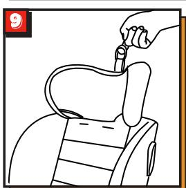
Primero afloje las correas. Levante el ajustador de altura del reposacabezas mientras mueve el reposacabezas a la altura de los hombros según la altura de su niño (Figura 9)
