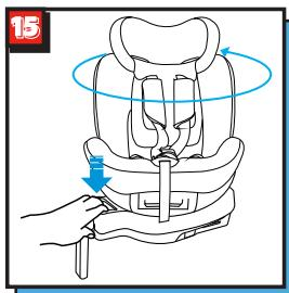
Pociągnij przycisk obrotu i jednocześnie obróć fotelik samochodowy w żądanym kierunku. (Rys.14,15)
