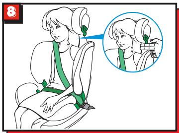
Beim Anschnallen mit dem Autogurt muss die Kopfstütze so eingestellt werden, dass zwischen der Kopfstütze und den Schultern des Kindes ein zwei Finger breiter Abstand besteht. Achten Sie darauf, dass der diagonale Teil des Gurtes an der Schulter des Kindes und nicht am Hals des Kindes anliegt (Abb. 8).
