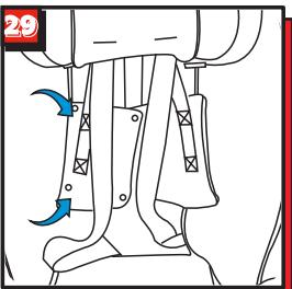
Lösen Sie die Schulterpolster und stecken Sie sie in die Abdeckung an den Seiten des Sitzes (Abb. 29).
