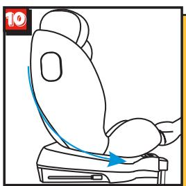
Автокресло имеет пять положений наклона. Для положения спиной вперед используйте только максимально откинутое положение. При положении лицом вперед можно использовать все пять положений. За исключением самого вертикального положения, другие положения могут подходить не для всех утвержденных транспортных средств. Потяните рычаг наклона и одновременно наклоните автокресло в нужное положение. (рис.10)
