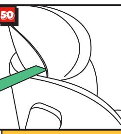
Вставьте диагональную часть ремня безопасности в держатель ремня так, чтобы она не перекручивалась. (рис.50)
