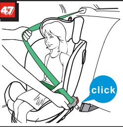
Haga que su niño se siente en la silla. Ajuste el reposacabezas a la altura deseada (vea sección 4.3). Saque el cinturón de seguridad del automóvil y páselo por delante del niño hacia la hebilla del asiento del automóvil. Inserte la lengüeta de la hebilla en la hebilla del asiento del automóvil. (Figura 47)
