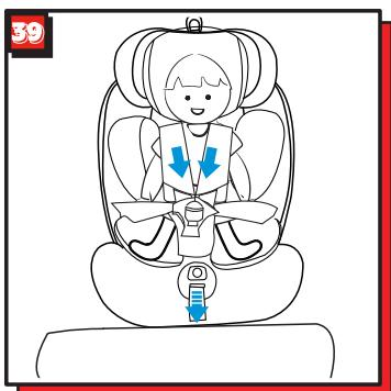
Setzen Sie das Kind in den Autositzen. Stellen Sie die Kopfstütze auf die gewünschte Höhe ein (siehe Abschnitt 4.3), stellen Sie den Gurt ein, schließen Sie das Gurtschloss und ziehen Sie den Gurt fest (siehe Abschnitt 4.1, 4.2) (Abb. 39).
