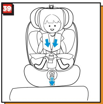
Coloque a su niño en la sillita. Ajuste el reposacabezas a la altura deseada (vea sección 4.3), ajuste los cinturones de seguridad, abroche la hebilla y apriete los cinturones de seguridad (vea secciones 4.1, 4.2). (Figura 39)
