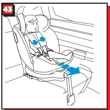
Setzen Sie das Kind in den Autositz. Stellen Sie die Kopfstütze auf die gewünschte Höhe ein (siehe Abschnitt 4.3), stellen Sie die Sicherheitsgurte ein, schließen Sie das Gurtschloss und ziehen Sie den Sicherheitsgurt fest (siehe Abschnitt 4.1, 4.2) (Abb. 43).
