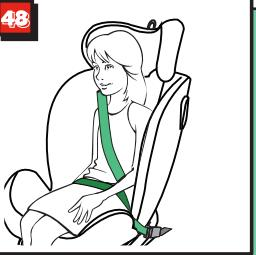
Поставете диагоналната част на предпазния колан и частта на надбедренния колан от страната на ключалката на предпазния колан на автомобила в долния водач на предпазния колан. (рис.48)
