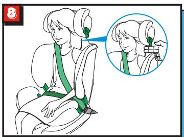
Podczas mocowania pasem samochodowym zagłówka należy wyregulować w taki sposób, aby między zagłówkiem a ramionami dziecka była przestrzeń o szerokości dwóch palców. Upewnij się, że ukośna część uprzęży znajduje się na ramieniu dziecka, a nie na jego szyi (rys. 8).
