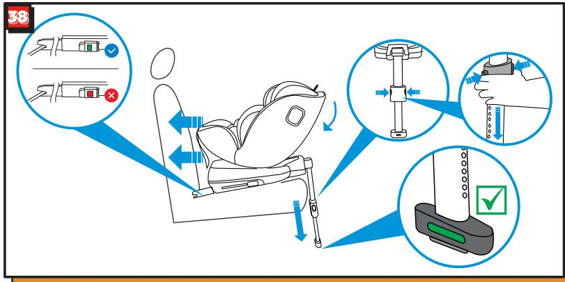
Instale el ISOFIX (vea sección 4.6). Instale la ata de apoyo (vea sección 4.7). (рис.38)
