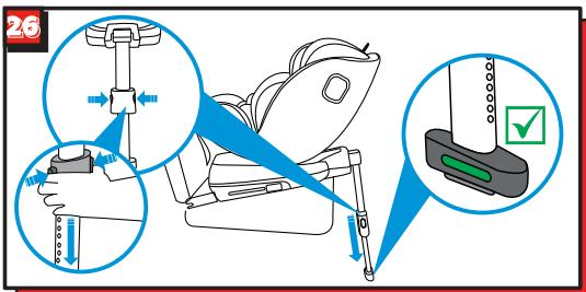
Vergewissern Sie sich, dass die Anzeigelampe an dem Stützfuß grün leuchtet, dass der untere Teil des Autositzes nicht über den Fahrzeugsitz hinausragt und dass die beiden Einstellknöpfe aus ihren Schlitten herausgefallen sind.
