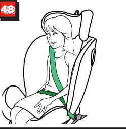
Coloque la parte diagonal del cinturón de seguridad y la parte del cinturón abdominal al lado de la hebilla del cinturón de seguridad del vehículo en la guía inferior del cinturón (Figura 48)
