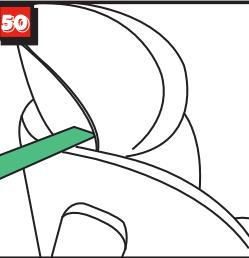
Führen Sie den diagonalen Teil des Sicherheitsgurtes so in den Gurthalter ein, dass er nicht verdreht ist (Abb.50). Der Einbau für eine Höhe von 100-150 cm ist ebenfalls nur mit dem Autogurt möglich, auch diese Einbaumethode ist geprüft und zugelassen. Wenn Sie diese Einbaumethode verwenden möchten, überspringen Sie einfach den ISOFIX-Einbau.
