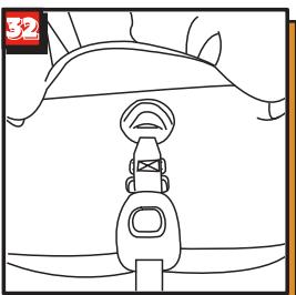
Coloque la hebilla del cinturón de seguridad en el hueco previsto. (Figura 32)
