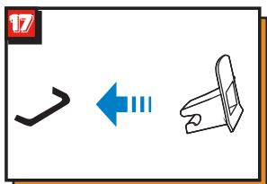
Si su vehículo no viene con rieles ISOFIX de serie, fije los dos rieles incluidos en el kit, con el lado cortado hacia arriba, a los dos puntos de montaje ISOFIX de su vehículo.
