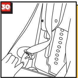
Вставьте защелки пряжек в углубления на внутренней стороне автокресла. (рис.30)
