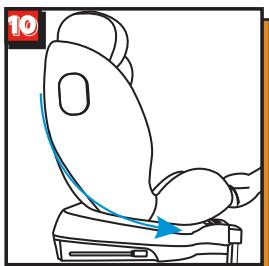
La silla tiene cinco posiciones de inclinación. Para una posición orientada hacia atrás, utilice sólo la posición máxima reclinada. Cuando se mira hacia adelante, puede utilizar las cinco posiciones. Con excepción de la posición más vertical, es posible que otras posiciones no sean adecuadas para todos los vehículos homologados. Tire de la palanca de reclinación y simultáneamente incline la silla a la posición deseada. (Figura 10)
