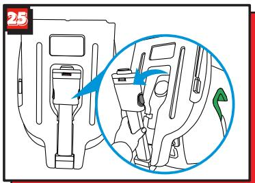
Ziehen Sie den Stützfuß von der Unterseite des Sitzes aus, bis er vollständig ausgefahren ist. Drücken Sie die 2 Einstellknöpfe und ziehen Sie den Stützfuß heraus, bis er auf dem Boden des Fahrzeugs aufliegt.
