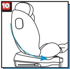
Fotelik samochodowy ma pięć pozycji odchylenia. W pozycji tyłem do kierunku jazdy należy używać tylko maksymalnie odchylonej pozycji. W pozycji przodem do kierunku jazdy można używać wszystkich pięciu pozycji. Z wyjątkiem najbardziej wyprostowanej pozycji, pozostałe pozycje mogą nie być odpowiednie dla wszystkich zatwierdzonych pojazdów. Pociągnij dźwignię odchylenia i jednocześnie odchyl fotelik samochodowy do żądanej pozycji. (Rys.10)
