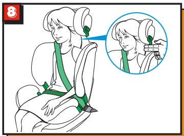
Cuando se fija con el cinturón de seguridad del coche, el reposacabezas debe ajustarse de manera que quede un espacio de dos dedos entre el reposacabezas y los hombros del niño. Asegúrese de que la parte diagonal del cinturón de seguridad quede en el hombro del niño y no en el cuello. (Figura 8)
