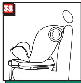
Захисний елемент від бокового удару слід встановлювати з боку, близького до дверей автомобіля.
