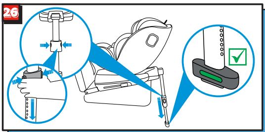
Pociagnij drążek podpierający od spodu siedzenia, aż zostanie całkowicie wysunięty. Naciśnij 2 przyciski regulacji i wyciągnij podpórkę, aż oprze się na podłodze pojazdu. Sprawdź, czy wskaźnik na podpórce świeci się na zielono, spód fotelika nie jest podniesiony ponad siedzenie pojazdu, a 2 przyciski regulacji wyskoczyły ze swoich gniazd.
