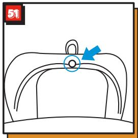
Desabroche los botones en la parte posterior del reposacabezas y retire la funda del reposacabezas.
