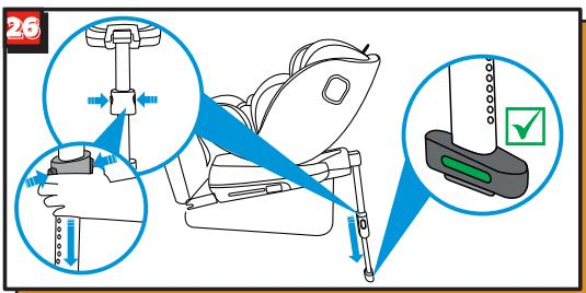
Tire de la pata de apoyo desde debajo de la parte inferior de la silla hasta que esté completamente extendida. Presione 2 botones de ajuste y extraiga la pata hasta que descance en el piso del vehículo.
