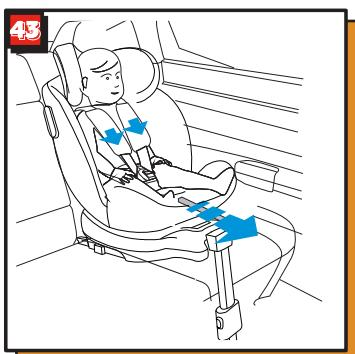
Coloque a su niño en la sillita. Ajuste el reposacabezas a la altura deseada (vea sección 4.3), ajuste los cinturones de seguridad, abroche la hebilla y apriete los cinturones de seguridad (vea secciones 4.1, 4.2). (Figura 43)
