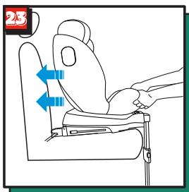
З зусиллям притисніть автокрісло до спинки сидіння. (рис.23)
