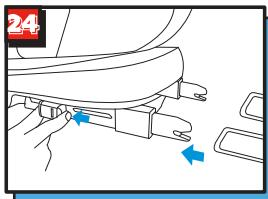
Naciśnij jednocześnie 2 przyciski ISOFIX i odłącz złącza ISOFIX. (Rys.24)
