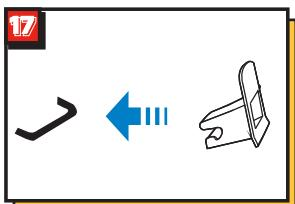
Если ваш автомобиль в стандартной комплектации не оснащен направляющими ISOFIX, прикрепите две направляющие, входящие в комплект, вырезом вверх к двум точкам крепления ISOFIX вашего автомобиля.
