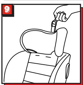
Lösen Sie zunächst die Gurte. Ziehen Sie den Höhenversteller der Kopfstütze nach oben und bringen Sie die Kopfstütze entsprechend der Größe des Kindes auf Schulterhöhe (Abb.9).
