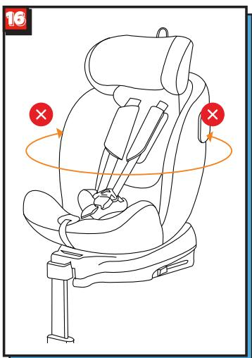
Gdy fotelik samochodowy zatrzyma się w żądanym kierunku, przycisk obrotu odbije się i wyda dźwięk kliknięcia. Następnie spróbuj obrócić fotelik samochodowy, aby upewnić się, że jest zablokowany. (rys. 16)
