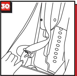
Setzen Sie die Gesperre des Gurtschlusses in die Aussparungen an der Innenseite des Sitzes ein (Abb. 30).
