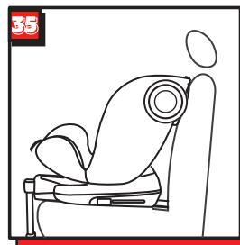
Das Seitenaufprallschutzelement muss auf der Seite angebracht werden, die der Fahrzeuggurt am nächsten liegt.
