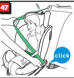
Попросите ребенка сесть в детское кресло. Отрегулируйте подголовник на нужную высоту (см. раздел 4.3). Вытяните ремень безопасности автомобиля и протяните его перед ребенком к пряжке сиденья автомобиля. Вставьте язычок пряжки в пряжку сиденья автомобиля. (рис.47)
