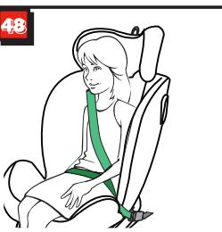
Поместите диагональную часть ремня безопасности и часть поясного ремня сбоку от пряжки ремня безопасности автомобиля в нижнюю направляющую ремня. (рис.48)
