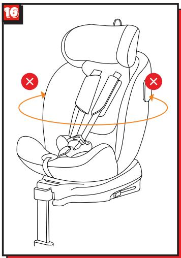
Wenn der Autositz in der gewünschten Richtung anhält, hüpfst der Drehknopf und gibt ein Klickgeräusch von sich. Versuchen Sie dann, den Autositz zu drehen, um sicherzustellen, dass er verriegelt ist (Abb. 16).
