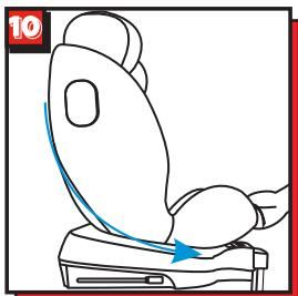
Der Autositz verfügt über fünf Verstelloptionen (Neigungspositionen). Verwenden Sie für die Rückenlehnenposition nur die maximale Neigungsposition. In der vorwärtsgerichteten Position können alle fünf Positionen genutzt werden. Mit Ausnahme der aufrechten Position sind die anderen Positionen möglicherweise nicht für alle zugelassenen Fahrzeuge geeignet. Ziehen Sie den Kipphebel und kippen Sie gleichzeitig den Autositz in die gewünschte Position (Abb.10).
