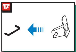
Якщо ваш автомобіль у стандартній комплектації не оснащений направляючими ISOFIX, прикріпіть дві напрямні, що входять до комплекту, вирізом до двох точок кріплення ISOFIX вашого автомобіля.
