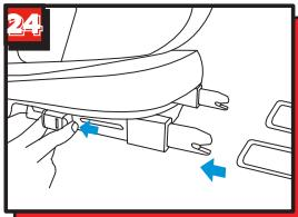
Drücken Sie gleichzeitig auf die 2 ISOFIX-Tasten und trennen Sie die ISO FIX-Anschlüsse (Abb.24).
