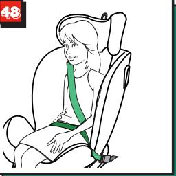
Помістіть діагональну частину ременя безпеки та частину поясного ременя збоку від пряжки ременя безпеки автомобіля до нижньої направляючої ременя. (рис.48)
