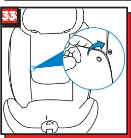
Bringen Sie die Abdeckung oben und unten wieder an (Abb. 33). Um die Sicherheitsgurte wieder anzubringen, gehen Sie in umgekehrter Reihenfolge vor. Achten Sie darauf, dass die Gурте nicht verdreht sind.
