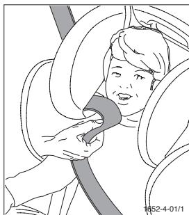
Legen Sie den Diagonalgurt in die Führung an der Kopfstütze ein.
