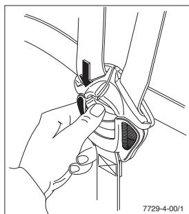
Öffnen Sie das Schloss durch Betätigen der roten Taste in Pfeilrichtung.
