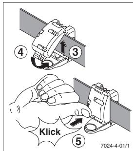
Diagonalni pas vstavite v sponko (3) in sledno zaprite (4) s slišnim klikom (5).
