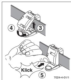
Inserire la cintura obliqua nel dispositivo di serraggio della cintura (3) e chiudere il dispositivo (4) fino a sentire il rumore di uno scatto (5).
