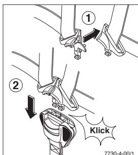
Fermez la boucle en assemblant les deux languettes (1) et en les encliquetant dans la boucle (celles-ci doivent faire «clic») (2).
