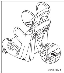
Ställ in huvudstödet i det 2:a läget nerifrån och för axelkuddens fästband bakåt genom öppningarna. För in skenan så som visas på bilden och för fästbanden över den.
