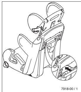
Placez l'appuie-tête à la deuxième position en partant du bas et faites passer les sangles de fixation de l'unité des coussins d'épaule vers l'arrière à travers les fentes. Introduisez le tube déflecteur comme indiqué et faites passer les sangles de fixation sur le tube.
