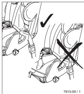
Indépendamment de l'utilisation du siège pour les classes d'âge I ou II+III, veillez au passage correct de la ceinture au niveau des points prévus à cet effet. La boucle de la ceinture doit se trouver au-dessous du point de passage de la ceinture.
