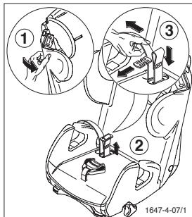
Zum Abnehmen der Schulterpolster nehmen Sie den Kopfstützenbezug ab und schieben die Schulterpolster durch die Gurtschlitz. Danach können Sie die Schulterpolstereinheit entfernen.
