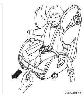
Tendez les bretelles en tirant sur la sangle centrale dans le sens de la flèche. Les bretelles doivent être serrées.
