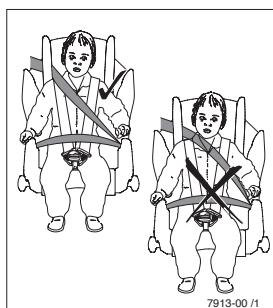
Indstil nakkestøtten til din barns størrelse, betjening som beskrevet på billede 2.7. Selen forløber optimalt over midten af kravebenet og ikke for tæt på barnets hals.
