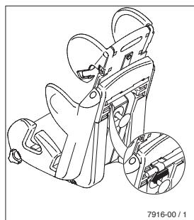
Bringen Sie die Kopfstütze in die oberste Position und lösen Sie die Sterngriffschraube. Ziehen Sie das Umlenkrohr etwas nach unten heraus und ziehen Sie die Befestigungsgurte der Schulterpolster ab. Entfernen Sie anschließend das Umlenkrohr.
