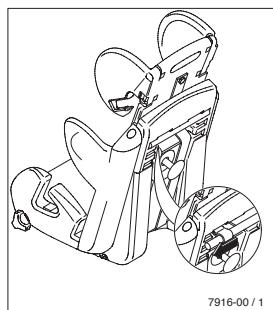
Mettez l'appuie-tête à la position la plus élevée et desserrez la vis à poignée en étoile. Retirez le tube déflecteur vers le bas et les sangles de fixation des coussins d'épaule. Retirez ensuite le tube déflecteur.
