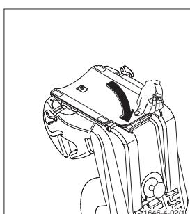
Drehen Sie die Bodenplatte zurück und drücken Sie sie wieder in die Aufnahmen.
