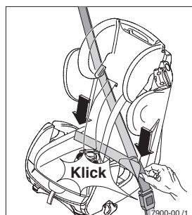
Fermez la boucle de la ceinture (celle-ci doit faire « clic ») et placez la partie du bassin de la ceinture trois points dans les guides-ceinture arrière via les tendeurs de ceinture.
