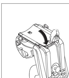
Sugražinkite apatinę plokštę į pirmykštę vietą ir vél užfiksokite įspausdami į tvirtinimo elementus.
