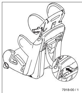
Portare il poggiatesta nella seconda posizione dal basso e far passare le cinghie di fissaggio dell'imbottitura delle cinghie a spalla attraverso la fessura verso dietro. Introdurre il tubo di rinvio come illustrato e farvi passare sopra le cinghie di fissaggio.
