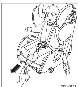
Spän bältena genom att dra i centralbältet i olien riktning. Bältena ska vara stramt spända.
