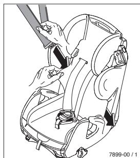
Ziehen Sie den Dreipunktgurt heraus, heben Sie den Kopfstützenbezug an und führen Sie den Gurt hinter dem Bezug durch.
