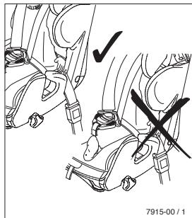
Obratite pozornost na pravilno uvođenje remena na težišnim točkama, neovisno o primjeni u grupama I ili II+III. Kopča uvijek mora biti ispod vodiča za pojasev.
