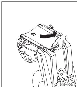
Klippen Sie die Bodenplatte aus und drehen Sie sie seitlich weg.
