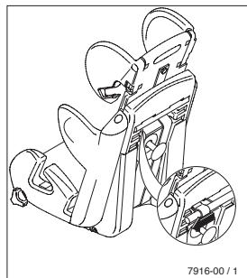
Portare il poggiatesta nella posizione superiore e allentare la vite a stella. Tirare il tubo di rinvio in basso, quindi staccare le cinghie di fissaggio delle imbottiture delle spalle. Rimuovere successivamente il tubo di rinvio.
