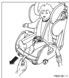
Straffen Sie die Gurte durch Ziehen des Zentralgurtes in Pfeilrichtung. Die Gurte sollten eng anliegen.
