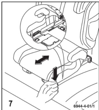
La posición de reposo se activa a través del ajuste de los conectores Seatfix. Para ello, apriete las palancas de retención y, desplazando el asiento para niños hacia adelante o hacia atrás, coloque el respaldo en la inclinación deseada.
