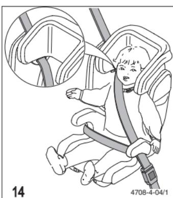
La guida della cintura per la spalla deve essere regolata un po' al di sopra della spalla. Così il bambino è allacciato correttamente nel seggiolino.
