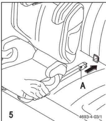
Зафіксуйте з'єднувачі Seatfix (A) в скобах Isofix, при цьому на обох з'єднувачах має бути видно зелену позначку. Перевірте міцність з'єднання, потягнувши за поверхню сидіння з обох боків.
