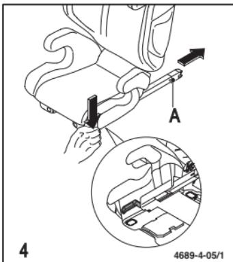
För att kunna montera bilbarnstolen i din bil måste Seatfix-adaptrarna (A) vara utdragna. Tryck för detta syfte på låsspakarna på båda sidorna på bilbarnstolen och dra ut Seatfixadaptrarna så långt det går i riktning bakåt.
