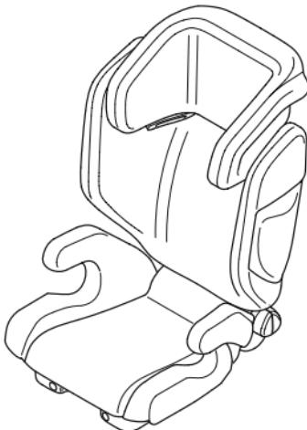
Solo adecuado para ser usado en vehículos dotados de cinturones de seguridad de tres puntos homologados conforme al reglamento CEPE n° 16 u otros estándares equiparables.
