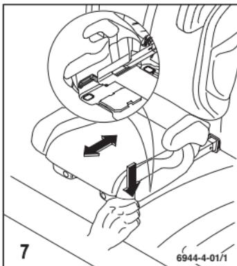
A nyugalmi helyzet a Seatfix-csatlakozók állításával aktiválható. Ehhez nyomja meg a rögzítőkart és állítsa a háttámlát a gyermekülés előre vagy hátrólásával a kívánt dőléspozícióba.
