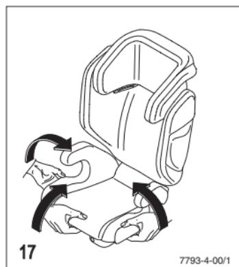
Retire las molduras de plástico inferiores de las respectivas hendiduras. Estire la funda por la parte exterior, comenzando por las guías del cinturón.
