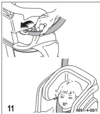
A continuación, coloque el cinturón diagonal en la guía de cinturón del reposacabezas.
