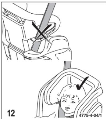
Плечовий ремінь безпеки при цьому повинен бути прикріплений тільки в напрямку назад! Дитяче сидіння слід використовувати лише на задньому сидінні автомобіля.
