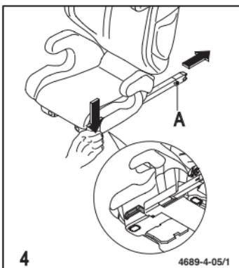
Для встановлення дитячого сидіння у Вашому автомобілі необхідно дістати з'єднувачі Seatfix (A). Для цього натисніть на фіксаторні важелі збоку сидіння і потягніть з'єднувачі Seatfix у напрямку назад до упору.
