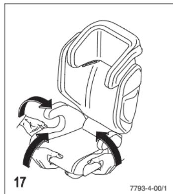
Retirez les barres inférieures des fentes. Retirez la housse des guidages des sangles en commençant de l'extérieur.
