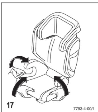
Ziehen Sie die unteren Kunststoffleisten aus den entsprechenden Schlitzen. Streifen Sie den Bezug von außen beginnend über die Gurtführungen.
