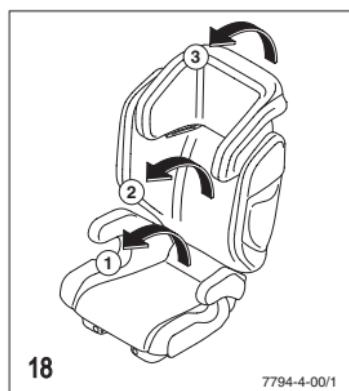
Retire la almohadilla del asiento hacia delante. Proceda de la misma manera para el respaldo y el reposacabezas.
