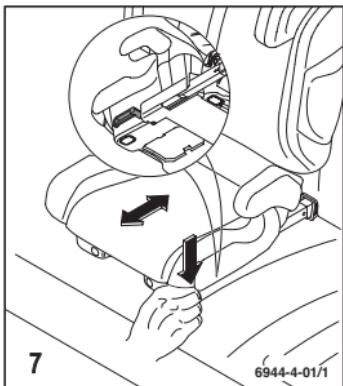
Die Ruheposition wird durch Verstellen der Seatfix-Konnektoren aktiviert. Drücken Sie dazu die Rasthebel und bringen Sie die Rückenlehne durch Vor- oder Zurückschieben des Kindersitzes in die gewünschte Neigungsposition.
