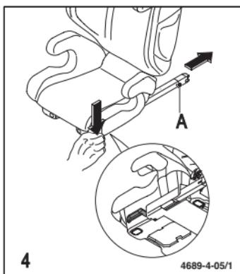
Zum Einbau in Ihr Fahrzeug müssen die Seatfix-Konnektoren (A) ausgefahren werden. Dazu drücken Sie die Rasthebel an den Seiten des Sitzteils und ziehen die Seatfix-Konnektoren nach hinten bis zum Anschlag heraus.
