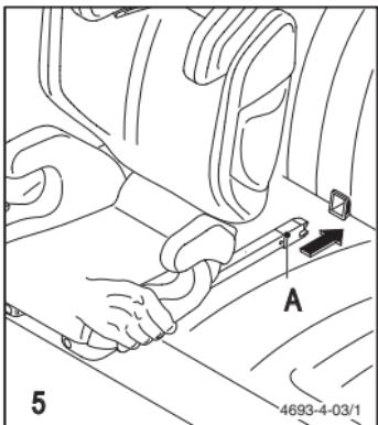
Innestare i connettori Seatfix (A) nelle staffe Isofix, in modo che sia visibile la marcatura verde sui due connettori. Controllare se sono innestati correttamente tirando il seggiolino da entrambi i lati.
