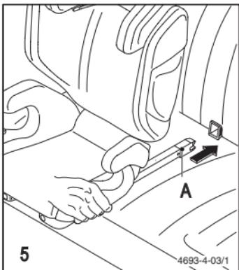
Ha rögzülnek a Seatfix csatlakozók (A) az Isofix kengyelekbe, akkor láthatóvá válnak a zöld jelölések a két csatlakozón. Ellenőrizze a megfelelő rögzülést az ülőfelület minden oldali meghúzásával.
