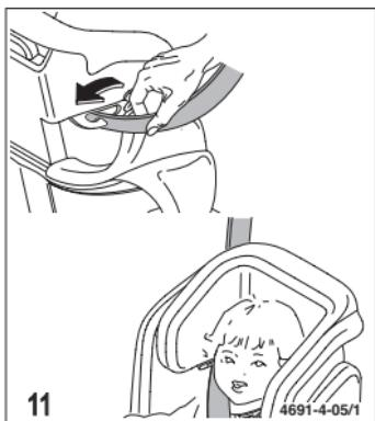
Diagonalni del avtomobilskega varnostnega pasu nato speljite skozi vodilo na opori za glavo.
