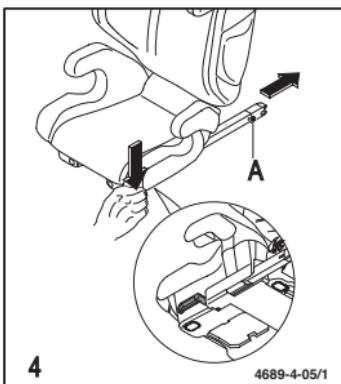
Pour le montage dans votre véhicule, les connecteurs Seatfix (A) doivent être sortis. Pour cela, appuyez sur les leviers de verrouillage placés sur les côtés de l'assise et sortez les connecteurs Seatfix en arrière jusqu'en butée.
