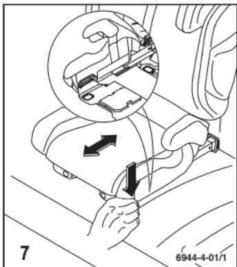
Лежаче положення активується шляхом регулювання з'єднувачів Seatfix. Для цього натисніть на фікаторні важелі і переведіть спинку в бажане похиле положення шляхом пересування дитячого сидіння назад або вперед.
