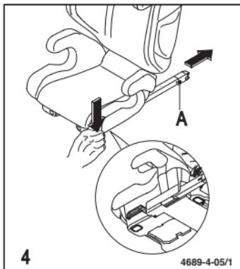
Per montare il sedile nel veicolo, estrarre i connettori Seatfix (A). Premere a tal scopo la leva di innesto situata ai lati del sedile e tirare indietro i connettori Seatfix fino alla battuta.
