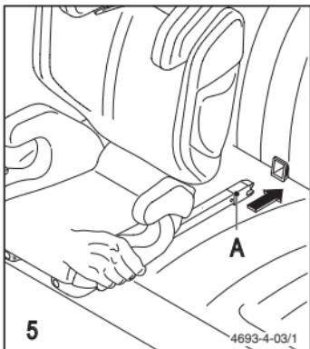
Encaje los conectores Seatfix (A) en los estribos Isofix. Durante esta operación tiene que verse la marca verde en ambos conectores. Compruebe el correcto anclaje tirando por ambos lados de la superficie del asiento.
