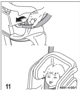
Læg efterfølgende tværselen ind i seleføringen på nakkestøtten.
