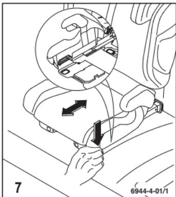
La posizione di riposo viene attivata regolando i connettori Seatfix. Premere a tal scopo le leve di innesto e posizionare lo schienale fino a raggiungere il grado di inclinazione voluto spingendo il seggiolino in avanti o indietro.
