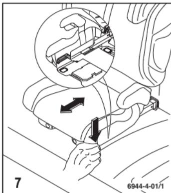
Положение для отдыха устанавливается путем регулировки коннекторов Seatfix. Для этого нажмите на запорные рычаги и приведите спинку в желаемое наклонное положение, двигая автокресло вперед или назад.
