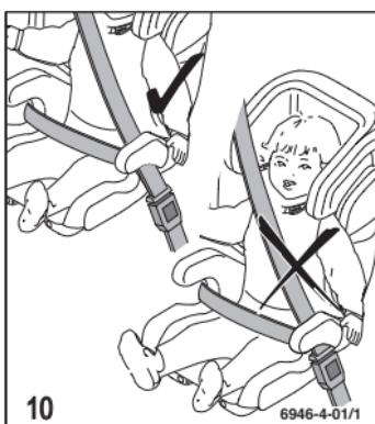
La serratura della cintura deve trovarsi al di sotto della guida nel seggiolino.
