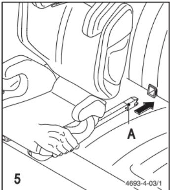
Rasten Sie die Seatfix-Konnektoren (A) in die Isofix- Bügel ein, dabei muss die grüne Markierung an beiden Konnektoren sichtbar werden. Prüfen Sie die sichere Verrastung durch beidseitiges Ziehen an der Sitzfläche.
