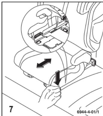
La position de repos est activée par le réglage des connecteurs Seatfix. Pour cela, appuyez sur les leviers de verrouillage et ajustez le dossier dans l'inclinaison souhaitée en avançant ou en reculant le siège pour enfant.
