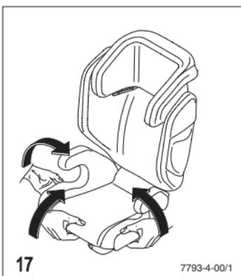
Spodnje plastične letvice potegnite iz njihovih zarez. Prevleko potegnite čez vodila za avtomobilski varnostni pas, vleči začnite od zunaj navznoter.
