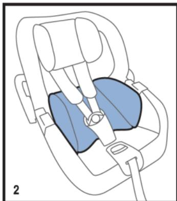
Als zusätzliches Element zur Anpassung ist die Babyschale mit einem Sitzverkleinerer ausgestattet. Dieser sollte entfernt werden, bevor die Kopfstütze zum ersten Mal in der Höhe verstellt wird.
