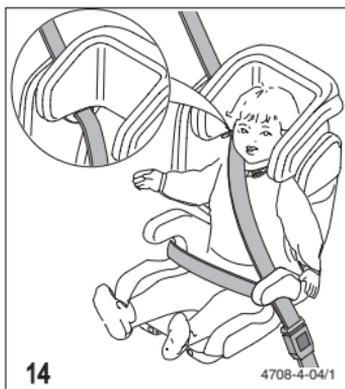
La guida della cintura per la spalla deve essere regolata un po' al di sopra della spalla. Così il bambino è allacciato correttamente nel seggiolino.
