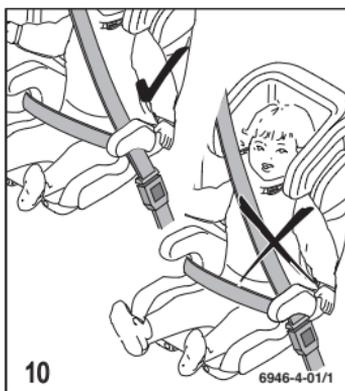
La serratura della cintura deve trovarsi al di sotto della guida nel seggiolino.
