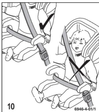
La serrure doit se trouver sous le guidage de la sangle du siège.
