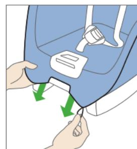
Alt oturma parçası kilitini çıkarmak için koltuk yuvasının alt kenarından kavrayın ve sabitleme halkalarını kancadan çıkarın. Koltuk yuvasını en ön pozisyon'a getirirseniz işlem daha kolay yapılabilir.
