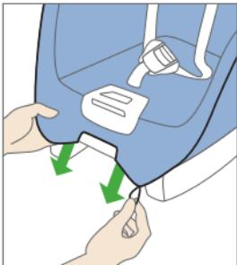
Zum Abnehmen des Bezuges für das untere Sitzteil greifen Sie unter den vorderen Rand der Sitzschale und haken Sie die Befestigungsschlaufen aus. Dies geht leichter, wenn Sie die Sitzschale vorher in die vorderste Position bringen.
