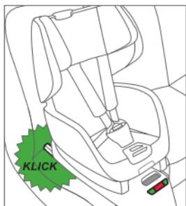
Теперь вставьте Optiafix в проушины системы ISOFIX, чтобы фиксаторы отчетливо защелкнулись.
