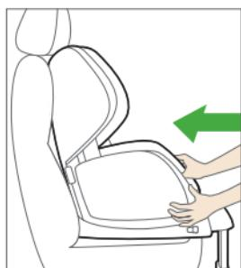
Ziehen Sie nun am Griff in der Mitte und schieben Sie die Optiafix Richtung Rückenlehne bis diese anliegt.
