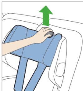
Для відпускання фіксатора треба потягнути вгору важіль на задній стінці.
