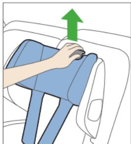
Для отпускания фиксатора надо потянуть вверх рычаг на задней стенке.
