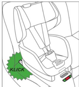
Așezați apoi Optiafix pe colierele ISOFIX și permiteți prinderea perceptibilă a elementelor de prindere.
