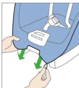
Para sacar la funda de la parte inferior del asiento, coja debajo del borde delantero del asiento y desabroche los lazos de sujeción. Esto resulta más fácil si coloca previamente el asiento en la posición más delantera.
