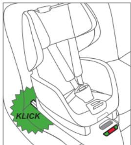
A continuación, coloque el Optiafix en los estribos ISOFIX y deje que los conectores encajen de forma audible.
