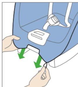
Klädseln på sätets underdel tas av genom att du tar tag under sätets framkant och hakar loss fästöglorna. Det går lättare om du först har skjutit fram sätet i det främsta läget.
