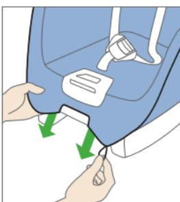
Per staccare la fodera della parte inferiore del seggiolino afferrare il bordo anteriore della struttura e sganciare i passanti di fissaggio. Tale operazione risulta più agevole portando la struttura del seggiolino nella posizione più avanzata possibile.
