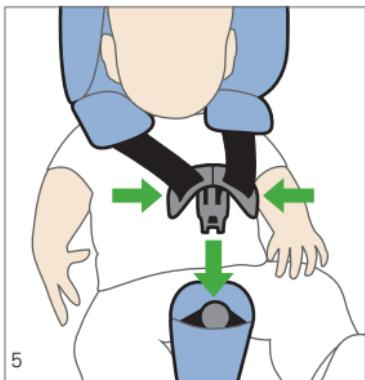
Führen Sie die Gurte über die Schultern des Kindes nach vorne und legen Sie die Gurtzungen aufeinander. Führen Sie nun die Schlosszungen in den Schlosskörper ein und lassen Sie diese hörbar einrasten.
