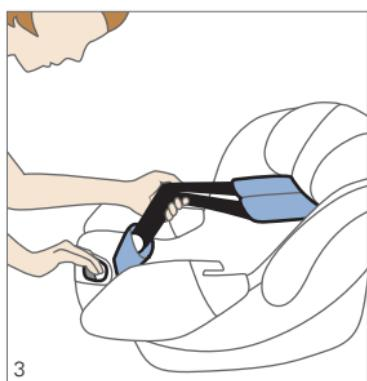
Lockern Sie zunächst den Schultergurt durch Betätigung der Gurtverstelltaste und Ziehen der Gurte nach vorne.
