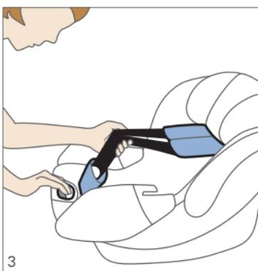
Innanzitutto allentare la cintura per le spalle azionando il tasto di regolazione e tirandola in avanti.
