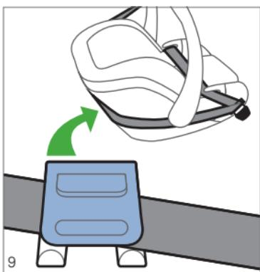
Вытяните плечевую часть ремня безопасности из направляющей автомобиля и положите его вокруг головной части автокресла-люльки. Потяните голубой рычаг на задней стороне автокресла вверх и проденьте ремень в направляющие, как показано на рисунке. Затем отпустите рычаг. При этом следите за тем, чтобы ремень не был скат.
