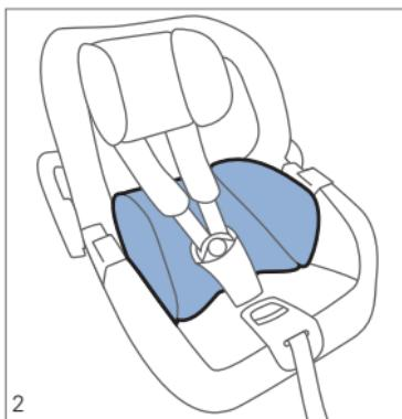
В качестве дополнительного элемента регулировки автокресло-люлька снабжено вкладышем для уменьшения сиденья. Он должен быть снят перед первой регулировкой подголовника по высоте.
