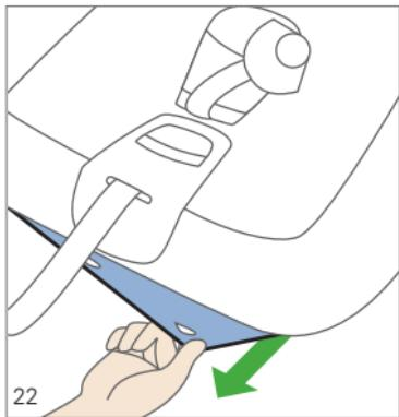
Lösen Sie den Bezug aus den Haken am vorderen Rand der Schale.
