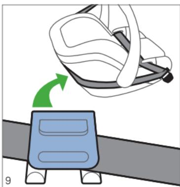
Estrarre la cinghia per le spalle dalla guida sull'autovettura e posizionarla attorno alla parte superiore del seggiolino auto. Spingere la leva grigia sul retro verso l'alto e inserire la cinghia nelle guide come illustrato. A questo punto rilasciare la leva. Assicurarsi che la cinghia non venga compressa.
